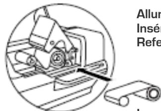
Allumez l'imprimante et soulevez la tête d'impression. Insérez le ruban dans le magasin et relevez les axes. Refermez la tête d'impression.
